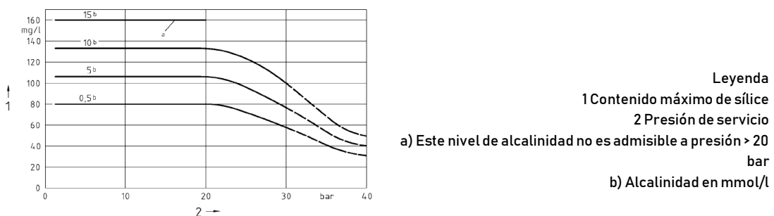
Fig. 5-2 Contenido de sílice máximo admisible (SiO 2 ) del agua de la caldera en función de la presión
